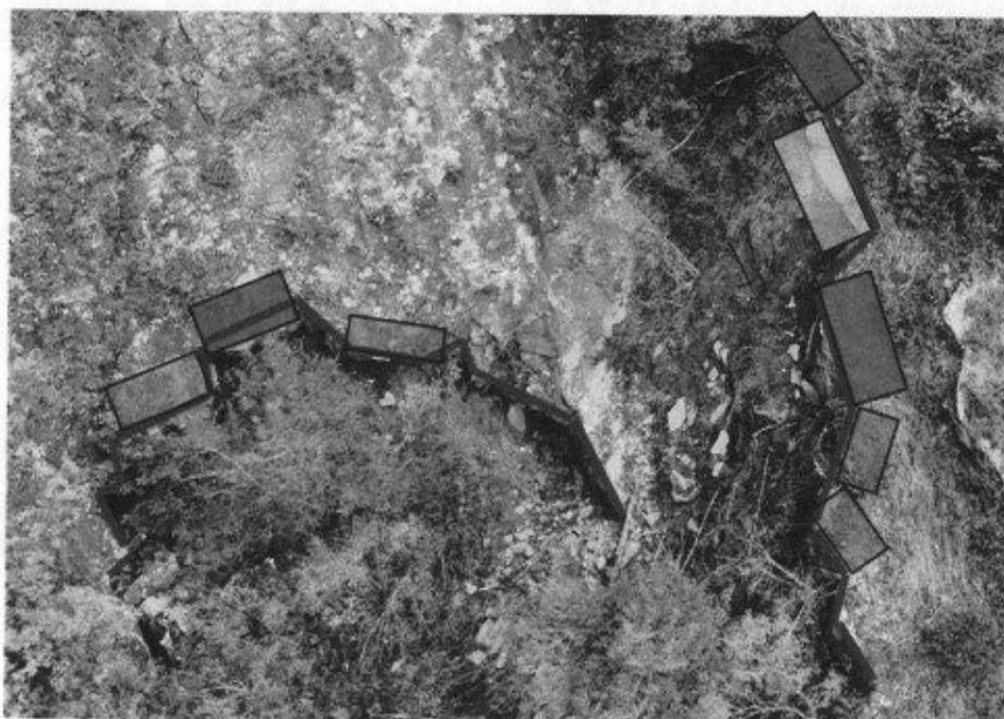
Figura 16: Rappresentazione molto schematica delle potenziali masse presenti nell'area di studio.
