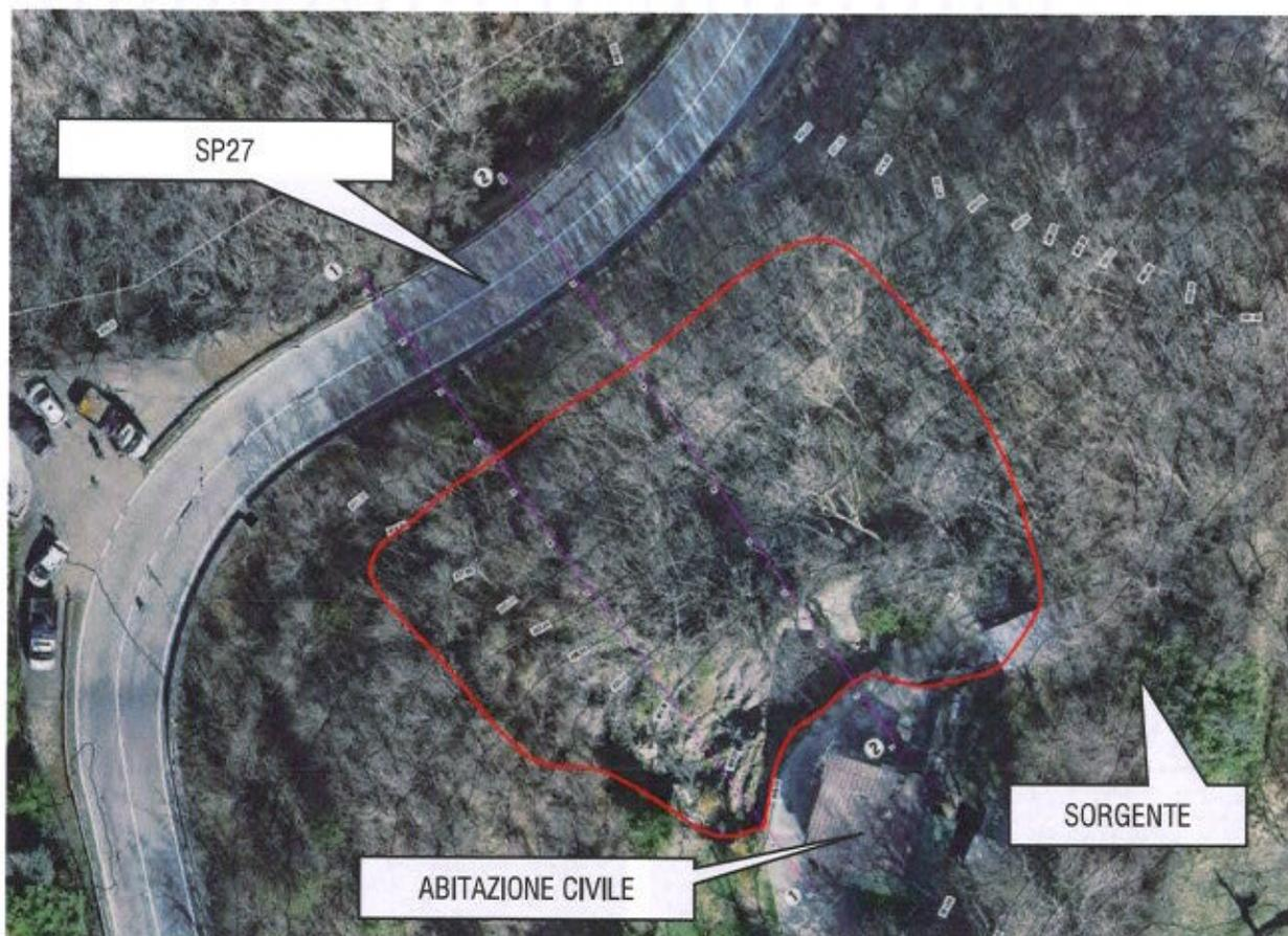
[Figura n. 2 – Indicazione estensione del dissesto su base ortofoto rilevata da UAV in data 19/03/2025]
