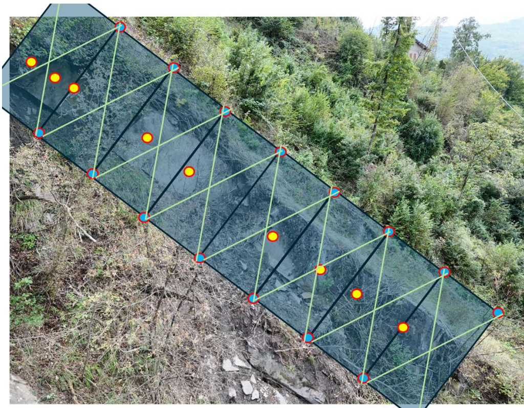
Figura 19: prospetto delle pannellature di sicurezza e degli ancoraggi laterali (pallini azzurri) e ancoraggi profondi (pallini gialli)
