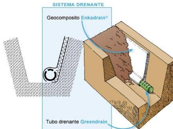
Rispetto ad altri sistemi, la realizzazione di trincee drenanti mediante l'utilizzo di questo prodotto presenta alcuni rilevanti aspetti di cui tenere conto, riguardanti l'esecuzione dei lavori.
