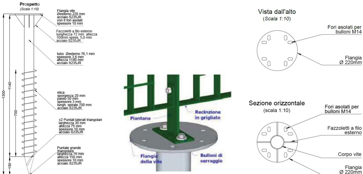
Ringhiera o cancellata di ferro a semplice disegno, con lavorazione saldata, incluse opere murarie, esclusi trattamenti protettivi e coloriture, del peso del peso medio indicativo pari a 25 kg/m<sup>2</sup>.
