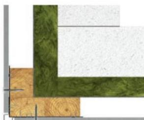
Formazione di un angolo esterno con profilo metallico HardiePanel™ MetalTrim™ di colore adeguato.
