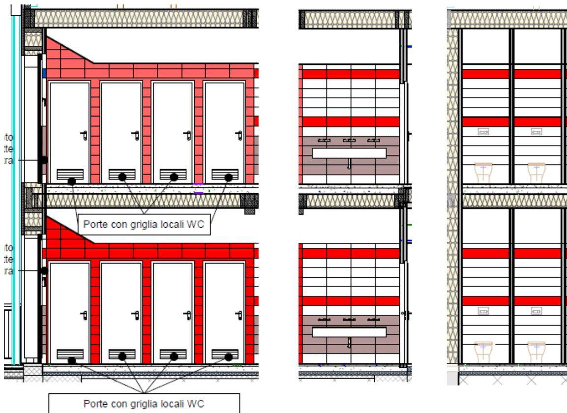
**Figura 6 – Prospetti bagni con rivestimento in gres**
