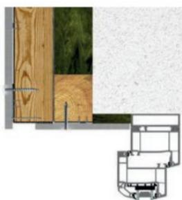
Chiusura di una facciata ventilata nell'area dell'architrave di una finestra con applicazione di una rete di protezione contro gli insetti e per aerazione.
