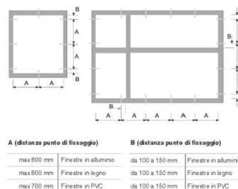
Il fissaggio del controtelaio (se previsto) alla muratura deve essere realizzato:
