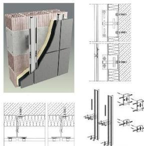
Sistema di facciata ventilata con montanti verticali
