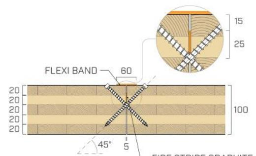
Figura 1 Nastro sigillante giunti in legno tipo Rhotoblaas Flexi Band o similare
