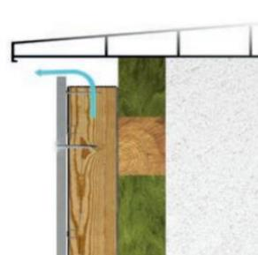
Descrizione della chiusura di un rivestimento HardiePanel® sul davanzale di una finestra al fine di assicurare una corretta ventilazione.
